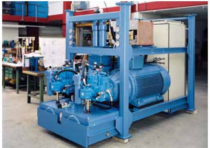
Aggregat mit 500 kW Antriebsleistung für Windkanalantrieb.
