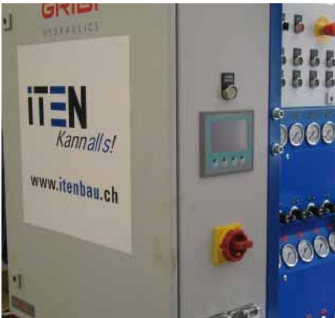
Hydraulik-Aggregat zu Prüfstand für Kraftwerkskomponenten.
